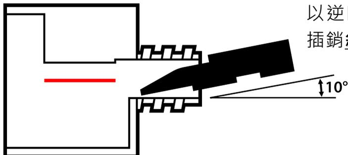
以逆時針方向，轉開泵浦下方排水鈕，再將插銷斜面朝上，以10度左右斜插入排水孔。
