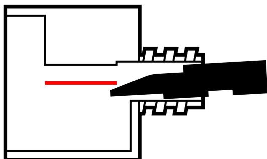
確認排水孔內的不鏽鋼彈片（圖片中紅色線段），位於插銷斜面上方後，將插銷向前慢慢推到底。
