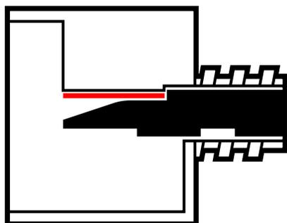
將插銷推到底後，不鏽鋼彈片將會完全固定。接著以順時針方向，裝上排水鈕。未來如需排水，請用尖嘴鉗夾住插銷凸起處，再向後移除。
