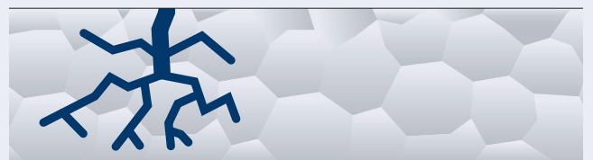
圖 1.6.10: 應力腐蝕破裂
