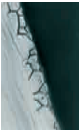
不銹鋼的晶界腐蝕
