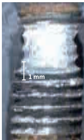
EN 1.4462 (SAF 205) 的縫隙腐蝕
